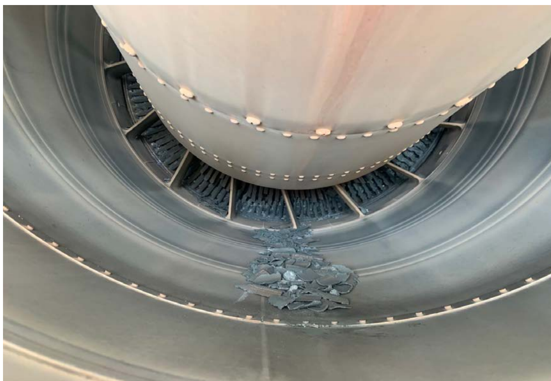
Зураг 5. Зүүн хөдөлгүүрийн хойд талаас, турбины эд ангиуд хайлж эмтэрсэн байдал
