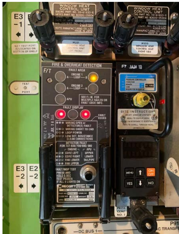
Зураг 6. Fire,overheat detection бүтгэгдсэн алдаа
