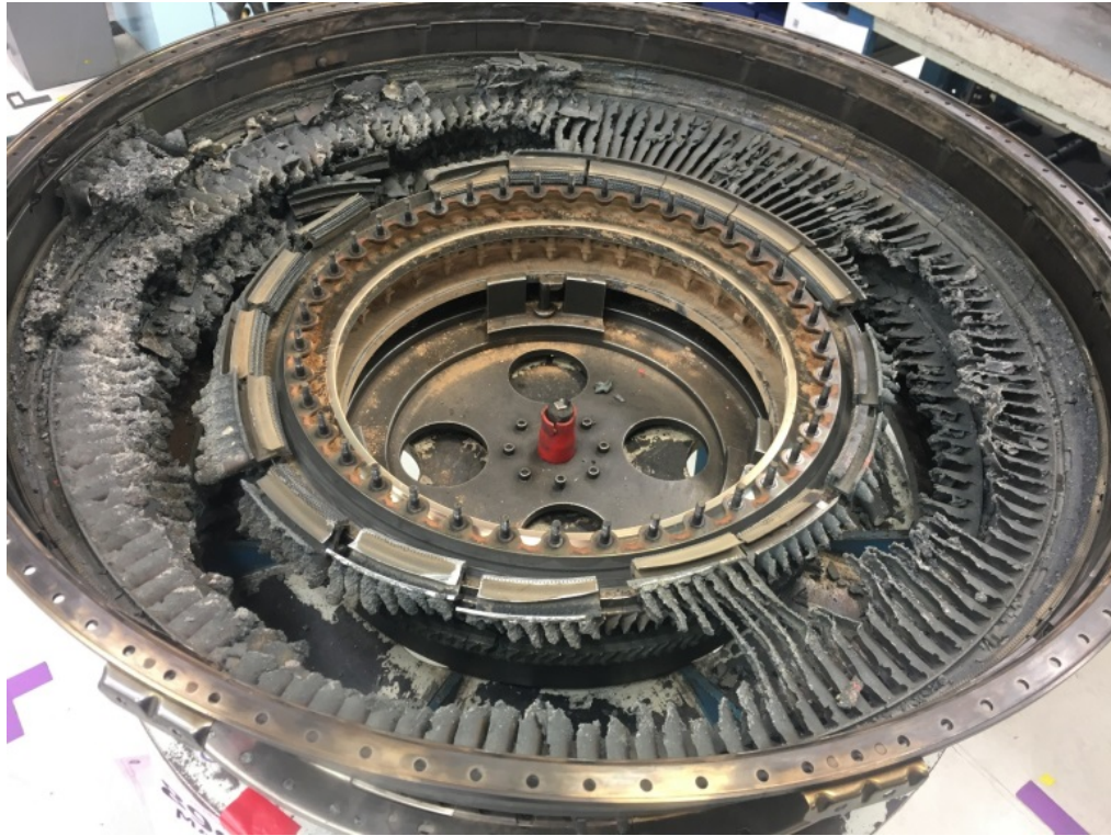
Зураг 16. Нам даралтын турбины эвдрэлийн хэсэг (LPT 54X)
