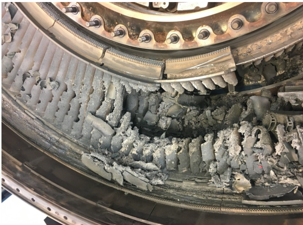
Зураг17. Нам даралтын турбины эвдрэлийн хэсэг (LPT 54X)
