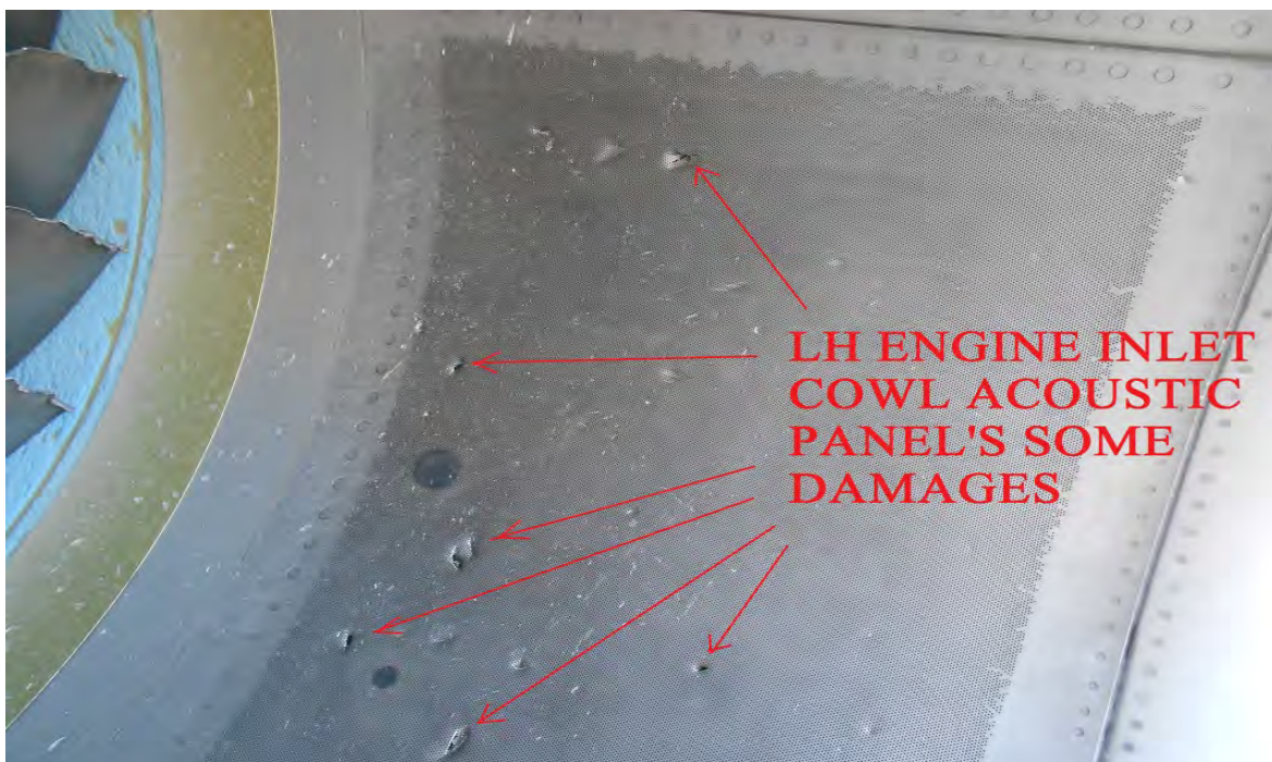
Зураг 12. Зүүн хөдөлгүүрийн inlet cowl acoustic panel эд ангийн гэмтэл
