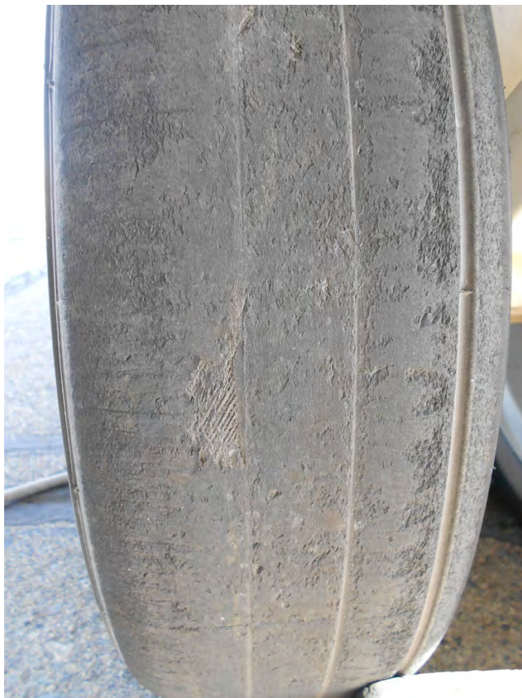
Зураг 17. Зүүн урд дугуйны хээний элэгдсэн байдал (хойд талаас авсан зураг)
