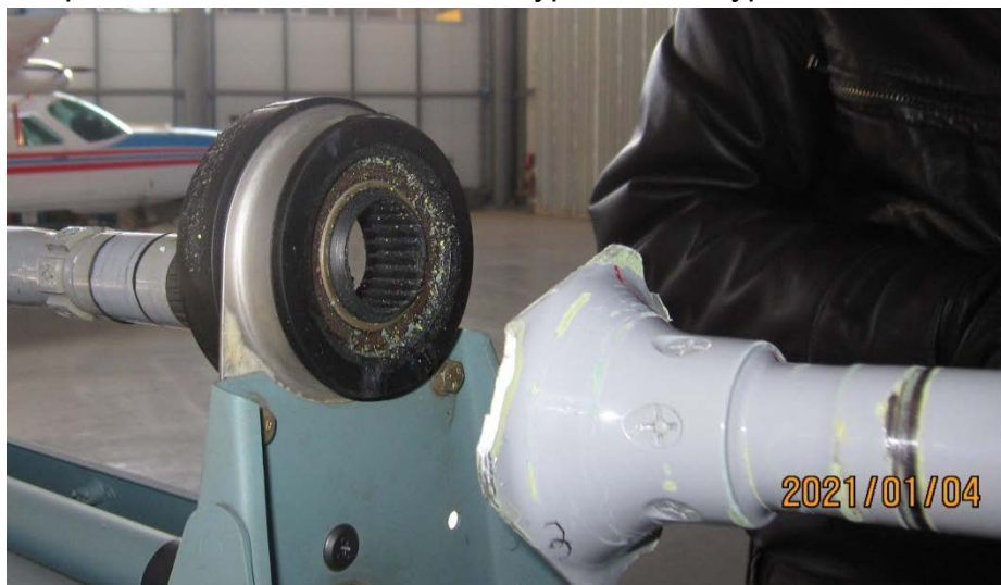
Зураг 10. Уян холбоос эвдэрсэн байдал
