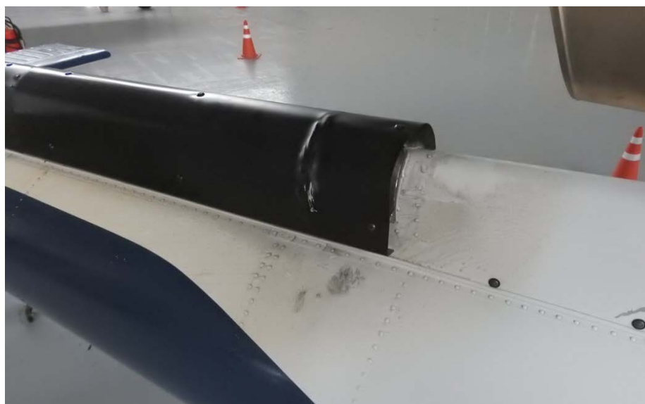
Зураг 11. Хаалт дотор талаас цохигдож эвдэрсэн байдал
