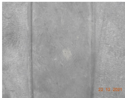
Зураг 12. 2-р дугуй төвийн хэсгээр элэгдсэн эхний үе гарахад ойртсон /144 цикл/
