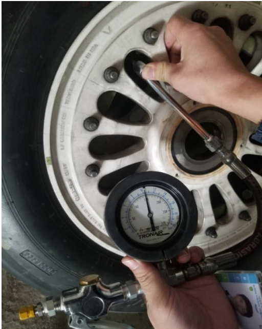
Зураг 10. 1-р дугуйны даралтын хэмжилт Аэромонголиа ХХК-н багажаар 150 psi . 2021.12.16
