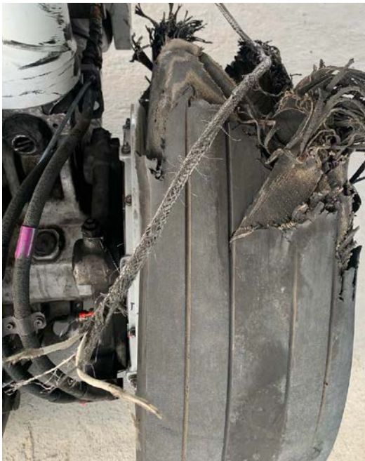
Зураг 3. Brake temperature sensor болон Proximity sensor-н wiring-н гэмтэл
