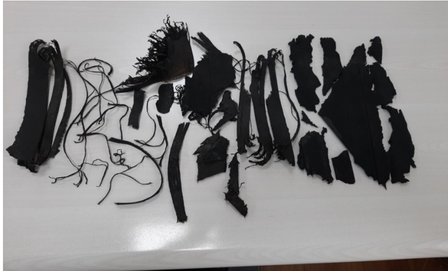
Зураг 21. Чингис хаан УОУНБ-ын Аэродромын үзлэг хяналтын инженер нь Хөөрөлт буултын зурваснаас олж илрүүлсэн агаарын хөлгийн дугуйны тасархай хаймар (FOD)-ууд.
